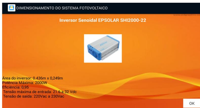
Figura 4 – Especificação do inversor
