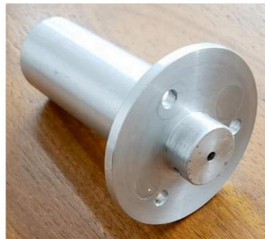
Figura 13: Cubo de Roda Fabricado.
