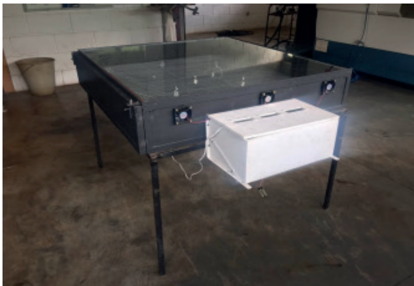
Figura 1 - Secador solar plano de exposição direta
