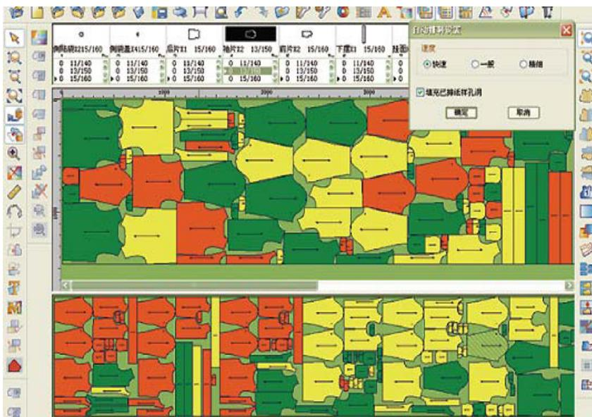
Fig. 3 - Programação no software RZ Cad Têxtil.
