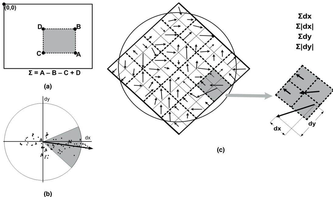
Figura 6: Processo de cálculo para o descritor SURF: (a) imagem integral; (b) janela deslizante de orientação com ângulo  $\pi/3$ ; (c) aplicação da máscara 8x8 alinhada com a orientação identificada e obtenção dos gradientes para cada direção na região sobreposta da imagem (esquerda), seguido do acúmulo dos gradientes para cada subregião (direita).
