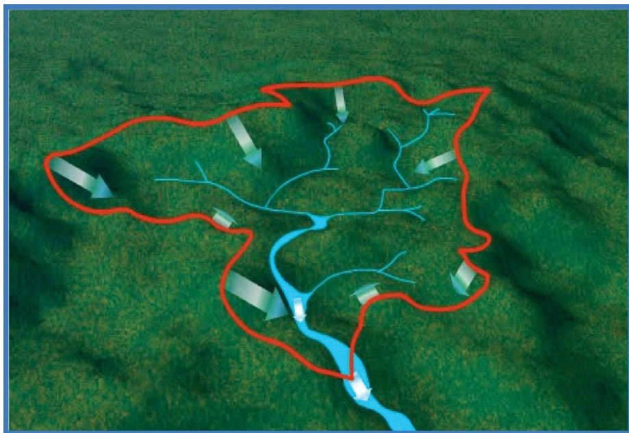
Figura 14 - Desenho esquemático de uma bacia hidrográfica.
