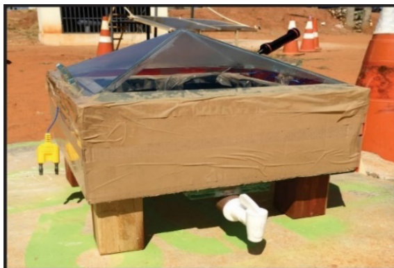
Figura 7: Destilador solar ajustado (Oliveira, 2018).
