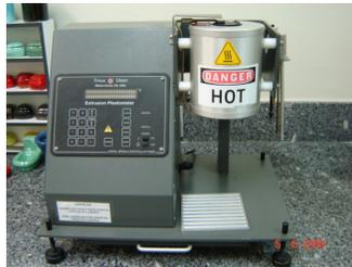
Figura 7 – Plastômetro Tinius Olsen MP993a.
