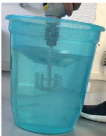
Figura 3. Teste do impelidor do tipo âncora em recipiente translúcido.
