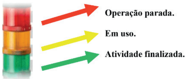
Figura 2 – Configuração da iluminação do sistema Andon
