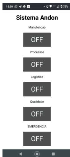
Figura 4– Sistema Andon via Web Server , sendo acessado por um dispositivo móvel
