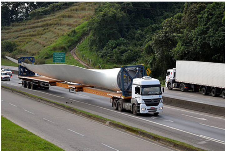
Figura 1- Transporte de pá eólica em uma rodovia
