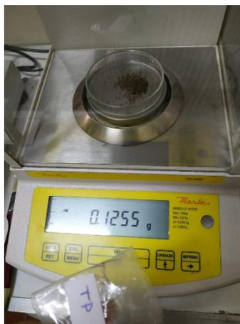
Figura 3- Massa de plântula de jambu obtida em balança de precisão 0,001.
