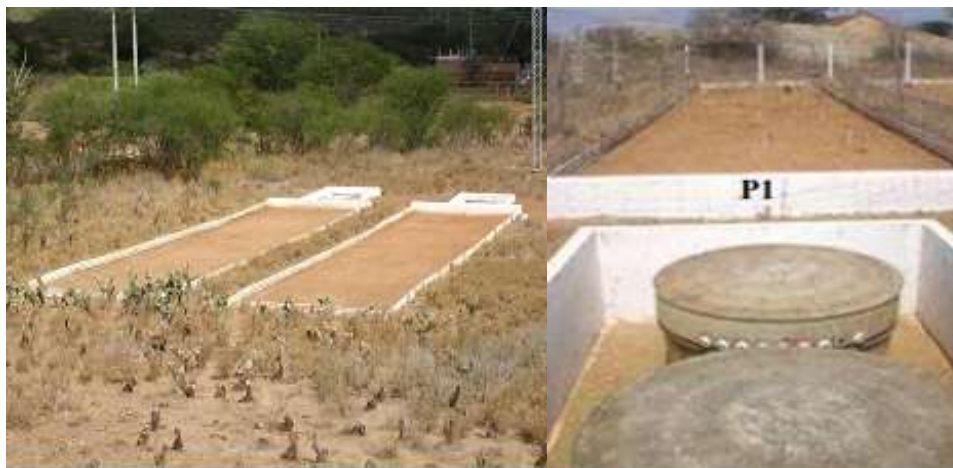
Figura 2. Área experimental com as parcelas de erosão tipo Wischmeier.
