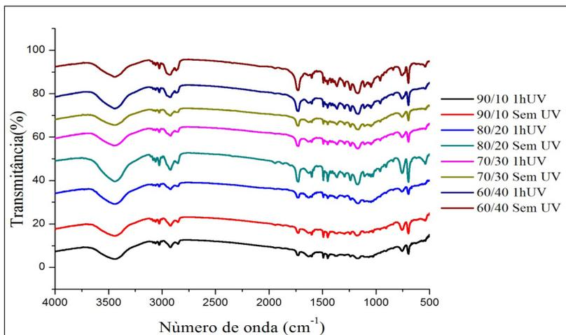
Figura 2 - Espectros de absorção IV das blendas PS/PCL em diferentes proporções sem exposição a luz UV-A e após a exposição à luz UV-A.
