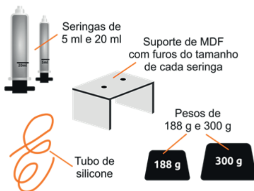
Figura 1: Materiais e representação do suporte de MDF finalizado.
