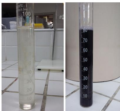
Figura 8 – Solução de amido/iodeto: a) Solução não oxidada; b) Solução oxidada.
