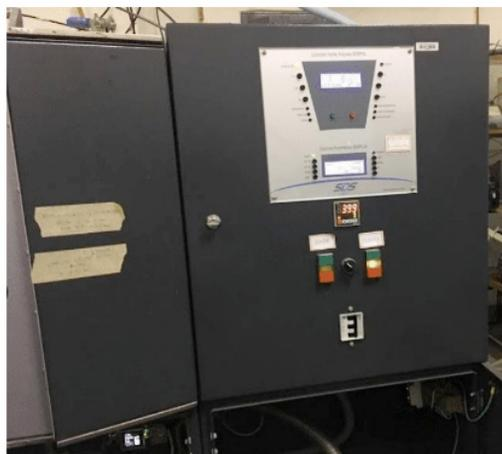
Figura 2: Reator de nitretação a plasma – Modelo: Thor NP300. Fabricante: SDS Plasma.
