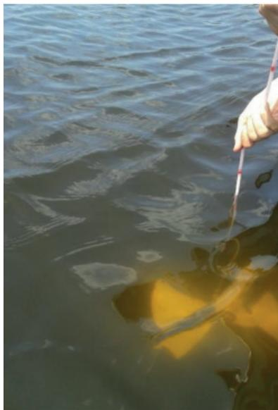
Figura 5: Análise da transparência da água do lado com o Disco de Secchi.
