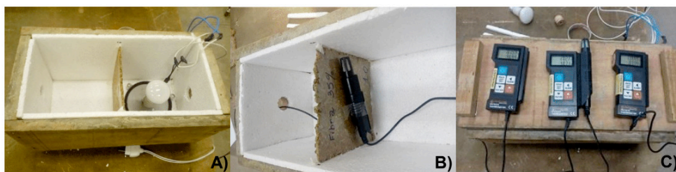
Figura 8 – A – Preparo do ensaio; B – Posicionamento do termômetro; C – Ensaio de desempenho térmico
