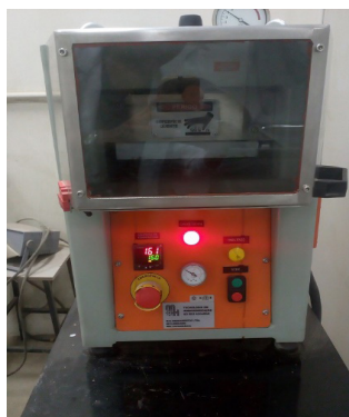
Figura 6 – Prensagem das placas
