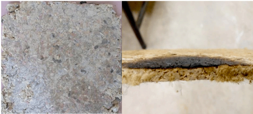
Figura 13 – Efeito das chamas nas placas
