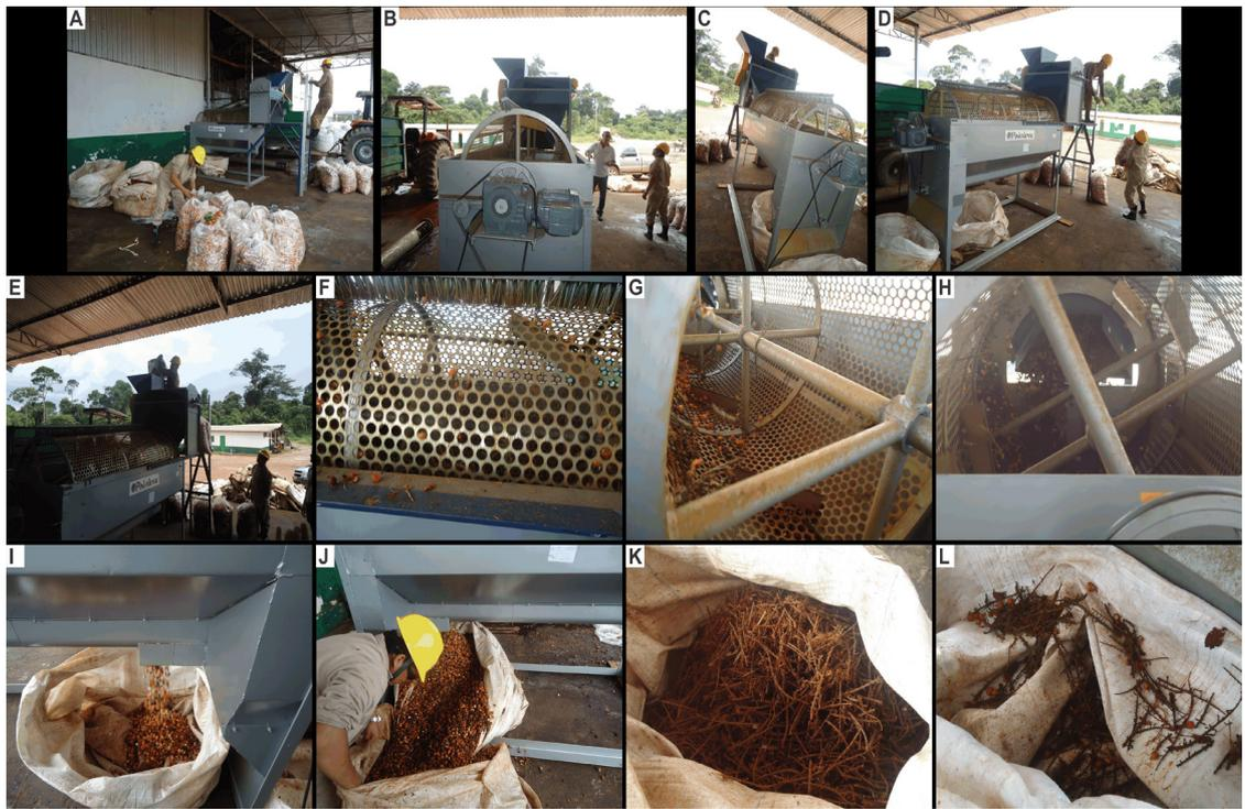
Figura 8 – Sequência de imagens dos testes com o primeiro protótipo de Desracemador mostrando vista geral do equipamento com os preparativos para os testes (a, b, c, d, e), detalhes do cilindro/batedor com peneiras (f, g, h), frutos livres dos racemos (i, j) e, racemos separados (k, l).
