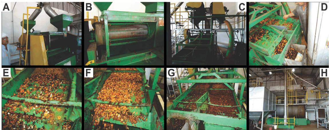
Figura 1 – Vista do maquinário antigo da Jayoro, constituído de despoldador (a, b), lavador/separador (c, d, e, f, g) e secador rotativo (h).
