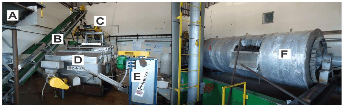
Figura 7 – Vista geral da Usina de Processamento Pós-Colheita de Guaraná instalada na Jayoro - A: Moega de Recepção; B: Transportador; C: Despolpador; D: Lavador/Separador; E: Deslizador e, F: Secador rotativo. Todos os equipamentos confeccionados em aço inoxidável.
