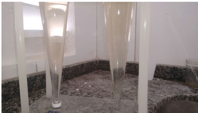
Figura 5 - Efluente dos decantadores (04/04/18)
