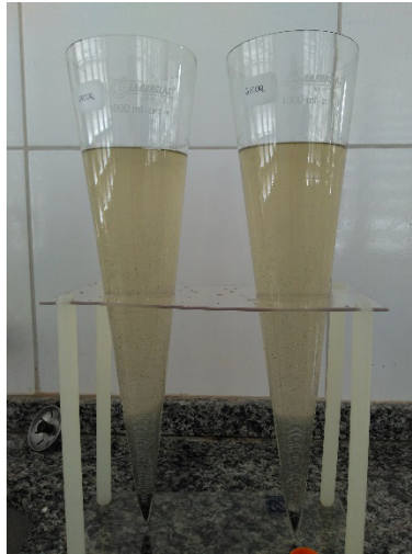
Figura 1 - Efluente dos reatores UASB (06/02/18)
