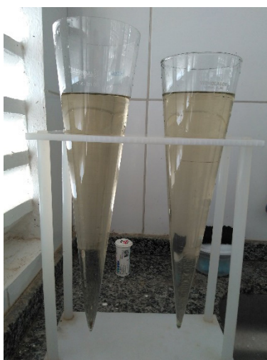
Figura 4 - Efluente dos decantadores (06/02/18)
