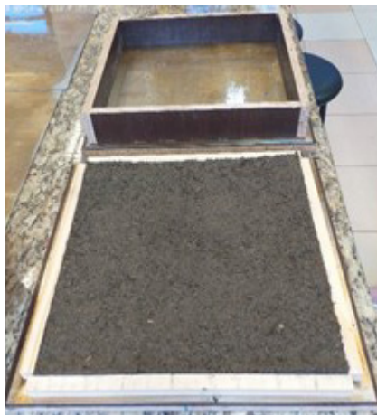
Figura 2. Processo de moldagem do painel
