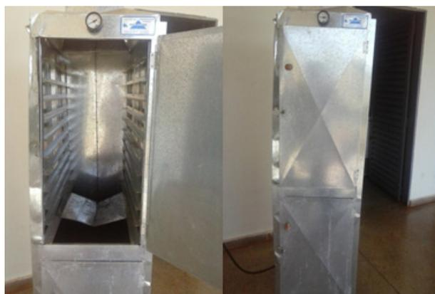
Figura 1 - Secador do tipo armário, com bandejas utilizado para a secagem do abacaxi.
