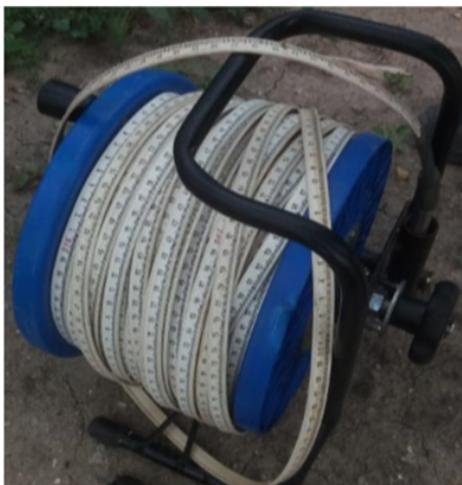
Figura 2. Medidor elétrico para nível de água.
