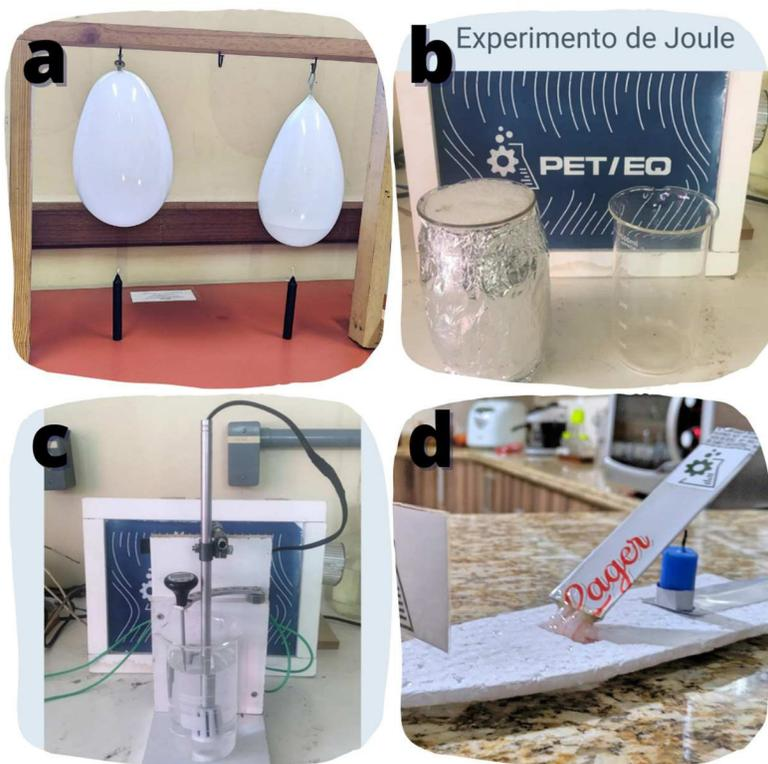
Figura 1 – Maquetes de termodinâmica do Projeto Escolas. Onde, a = experimento dos conceitos básicos; b = experimento da primeira lei; c = experimento da primeira lei; d = experimento da segunda lei.
