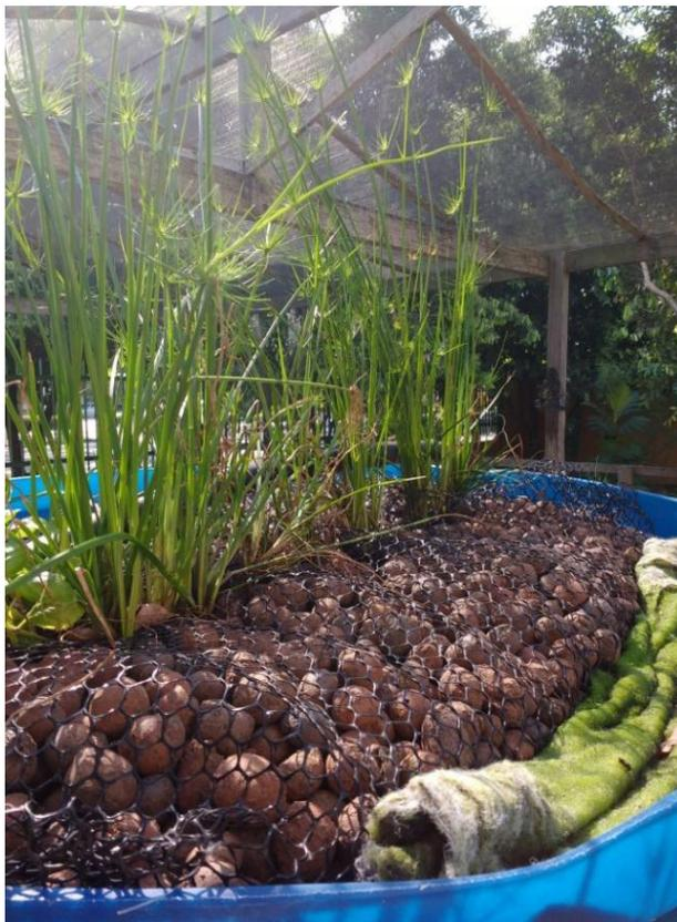
Figura 5 - Filtro biológico utilizado no sistema aquapônico instalado em uma escola em parceria com o IFAM CITA, utilizando *perloma* entrada de água como filtro mecânico, argila expandida como substrato e mudas de papiros.
