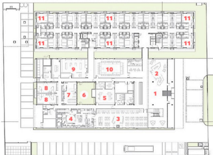
Figura 2: Planta baixa do Hotel Linx International Airport Galeão com quartos acessíveis localizados nos números 11 do lado esquerdo.
