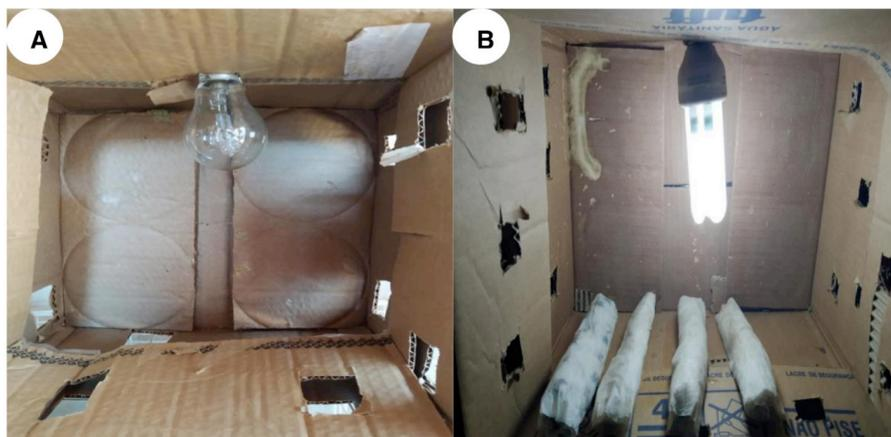
Figura 1. Câmara B.O.D. artesanal (A) com uso de lâmpada incandescente e; (B) com uso de lâmpada fluorescente com rolos de papel toalha. *B.O.D. handmade (A) using incandescent lamp and; (B) using fluorescent lamp with paper towel rolls.*
