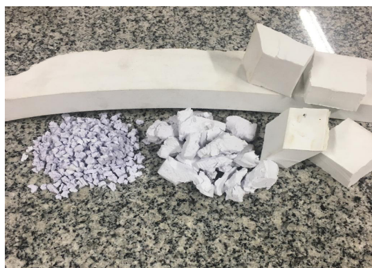
Figura 2. EVA na forma de aparas e grânulos de coloração cinza fornecido por uma indústria calçadista do município de Vitória da Conquista-BA.
