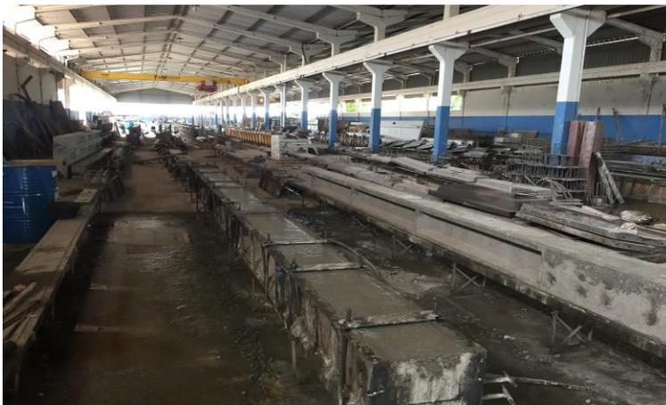
Foto 2 – Formas e Concretagem dos pré-moldados
