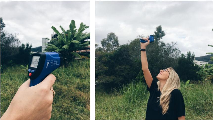
Figura 01 - Ilustração de um termômetro de infravermelho (marca FLUS IR-802) usado para medidas da temperatura aparente da atmosfera a partir do zênite celeste.
