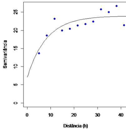
Figura 6: Ajuste do semivariograma para a amostragem sistemática.
