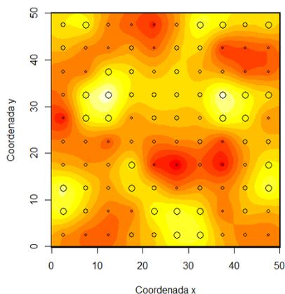
Figura 9: Krigagem para a amostragem sistemática.
