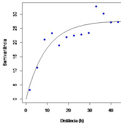
Figura 5: Ajuste do semivariograma para a amostragem estratificada.
