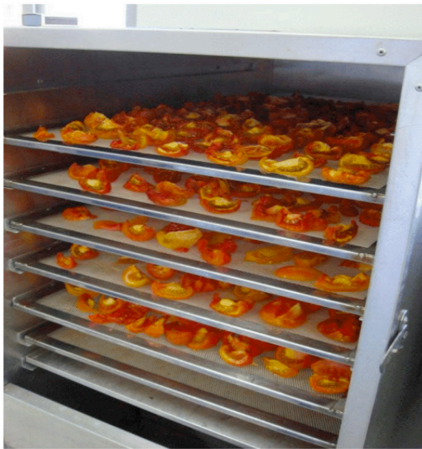
Figura 8 – Distribuição dos tomates no desidratador de cabine.
