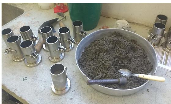
Figura 9 – Moldagem dos corpos de prova cilíndricos.
