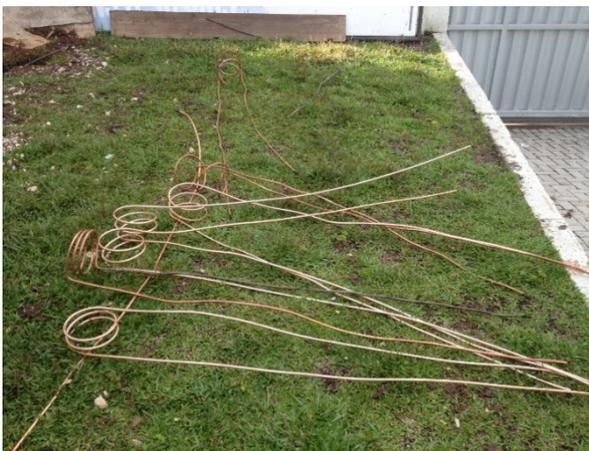
Foto 4 – Trocador de calor do evaporador
