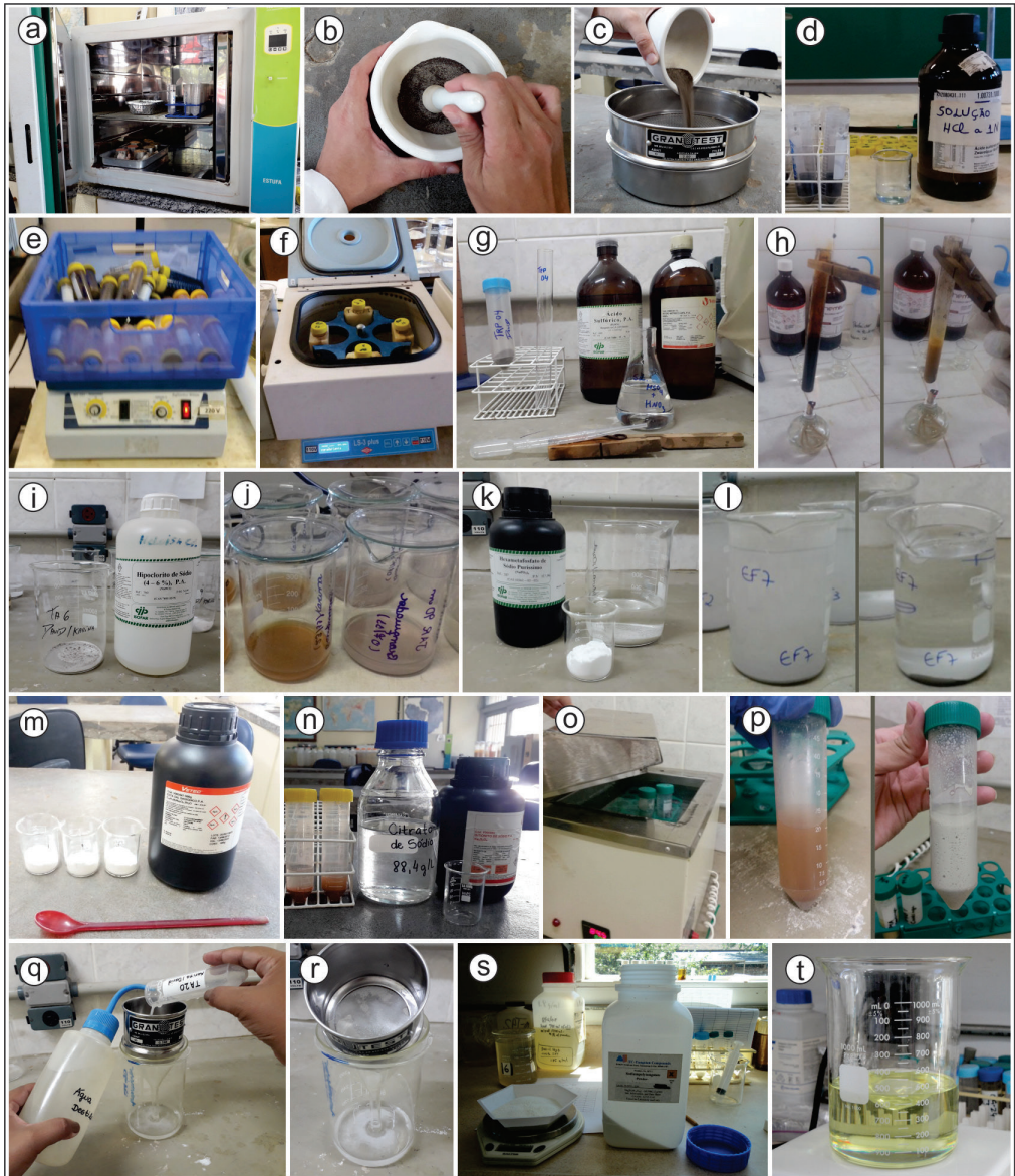
Figura 1: Etapas da extração de fitólitos de solos/ sedimentos: a) Secagem das amostras na estufa ventilada; b) Destorroamento da amostra; c) Peneiragem (2 mm) da amostra; d) Remoção dos carbonatos; e) Amostras no agitador mecânico orbital; f) Amostras na centrífuga; g) Preparação da solução ácida para oxidação da matéria orgânica; h) Oxidação da matéria orgânica (antes e depois); i) Preparação para o branqueamento com hipoclorito de sódio; j) Antes e depois do branqueamento; k) Preparação para remoção da fração argila com Hexametafosfato; l) Antes e depois da remoção da fração argila; m) Preparação para remoção da fração argila com EDTA; n) Preparação dos reagentes para solubilização do ferro; o) Amostras em banho-maria para solubilização do ferro; p) Antes e depois da solubilização do ferro; q) e r) Remoção da fração areia; s) Preparação do líquido denso com SPT; t) Solução de SPT na densidade de 2,31g/ml. Fonte: Adaptado de Machado (2019)
