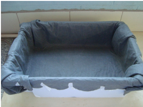
Figura 06 Bandeja furada revestida com manta geotêxtil
