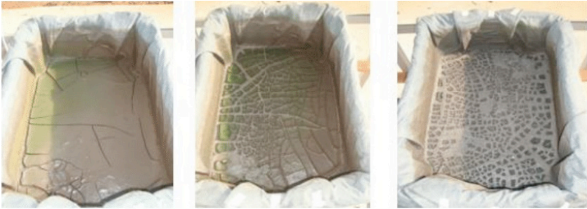
Figura 11 - Evolução da secagem do lodo retirado do FDML, com 3, 5 e 7 dias, respectivamente.
