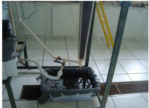
Figura 07 Bandeja com lodo descarregado sobre a manta geotêxtil
