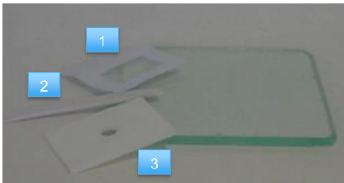
FIGURA 1 – Materiais descartáveis para confecção de lâminas pela técnica de Kato-Katz: tela de filtro (1), espátula (2) e placa perfurada (3).
