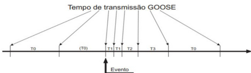
Figura 3. Mecanismo de retransmissão GOOSE (OLIVEIRA; LOPES, 2018).
