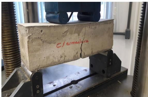
Figura 5: Propagação da fissura através do entalhe (Autor)
