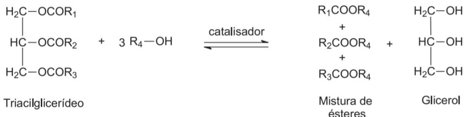
Figura 1: Transesterificação de triglycerídeos, onde R1, R2 e R3 representam as cadeias carbônicas dos ácidos graxos e R4 a cadeia carbônica do álcool reagente.
