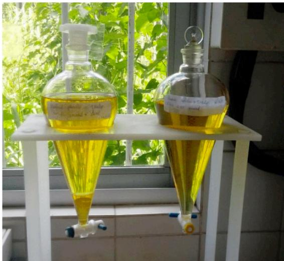
Figura 2: Purificação do biodiesel produzido.
