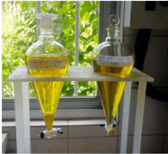
Figura 2: Purificação do biodiesel produzido.
