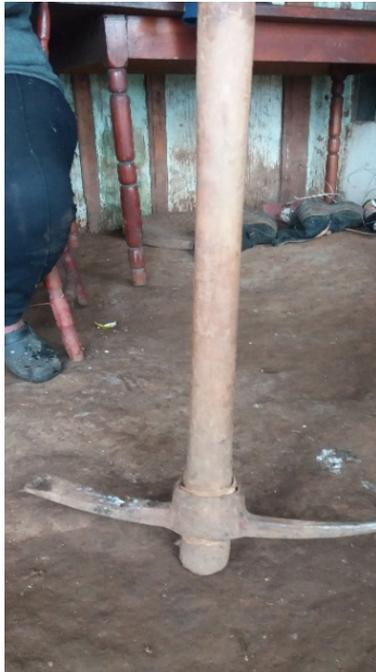
Figura 02: Picão - ferramenta utilizada para a extração das pedras
