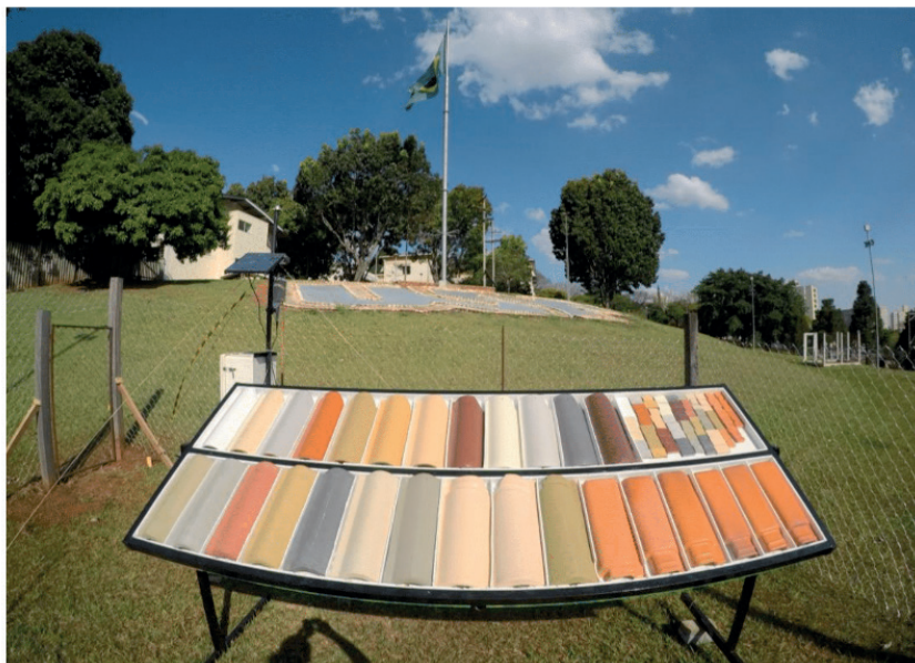
Figura 2 – Sistema de suporte das telhas para exposição às intempéries e medições de temperaturas superficiais.
