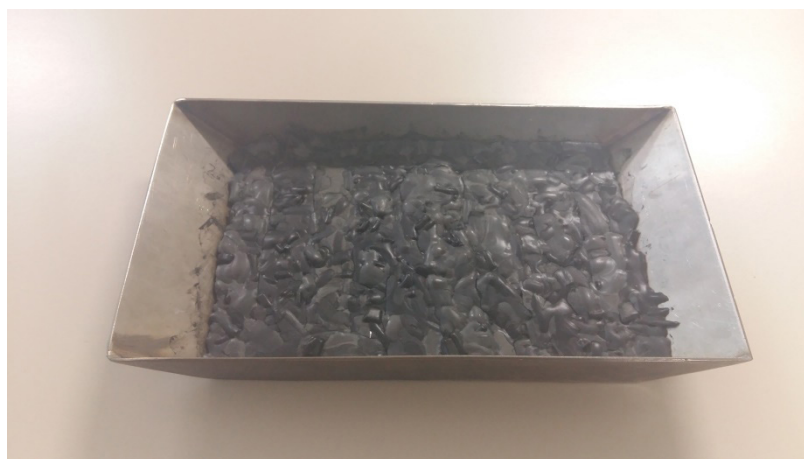
Figura 2: Fôrma de aço inox utilizada para o molde das placas de PP.
