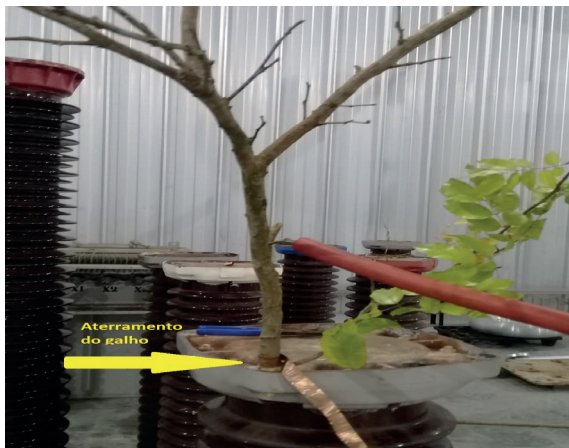
Fig. 5 – Galho aterrado em testes de FAI na Fonte Ressonante. Fonte: Leão,2019
