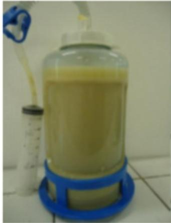
Figura 1 – Fermentador Descontínuo Adaptado
