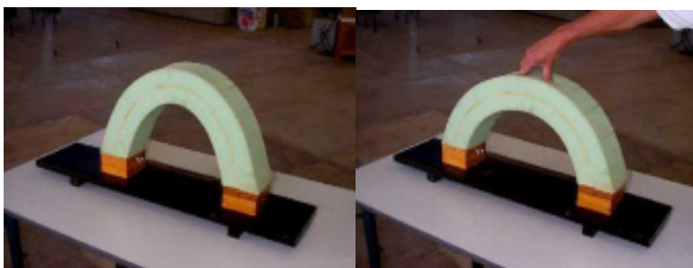
Figura : Utilizando-se um arco de espuma pode-se observar a reação horizontal, resultante do carregamento. Desenvolvido pela Aluna Priscilla Rosa, UNICAMP.
