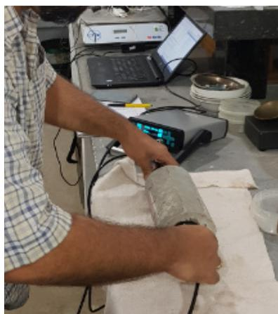
Figura 5 – Realização de ensaio de pulso ultrassônico
