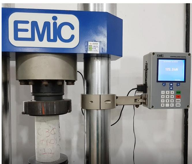
Figura 7 – Execução do ensaio à compressão
