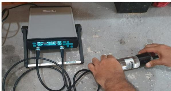
Figura 4 – Calibração do ultrassom
