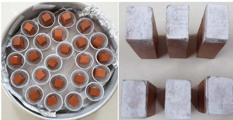
Figura 2 – Visão superior das mostras imersas \*0% em água destilada (esquerda) para a formação de eflorescência (direita).
