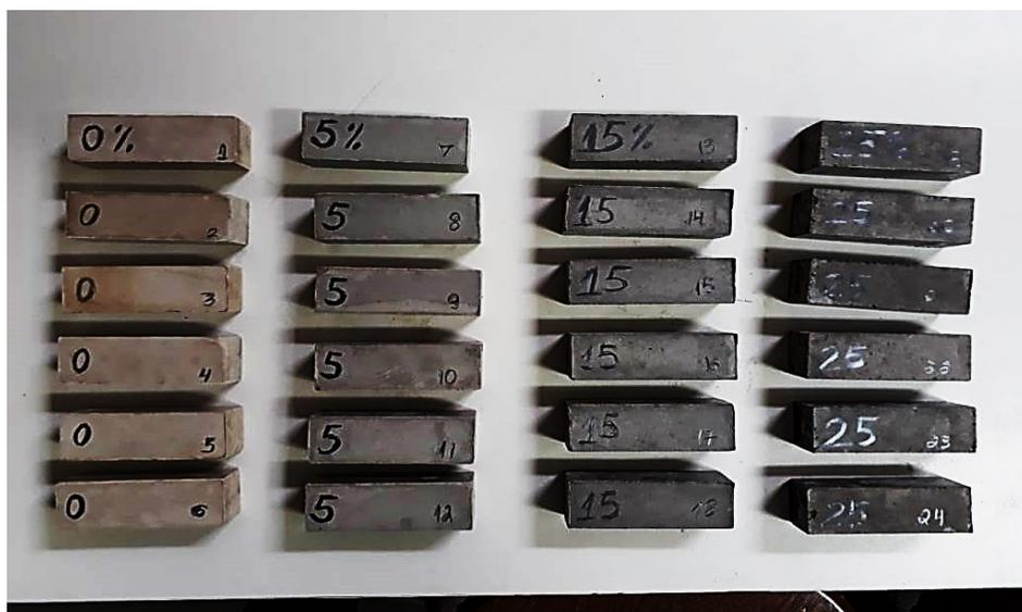
Figura 1 – Coloração dos corpos de prova com diferentes teores de resíduo (%m.).
