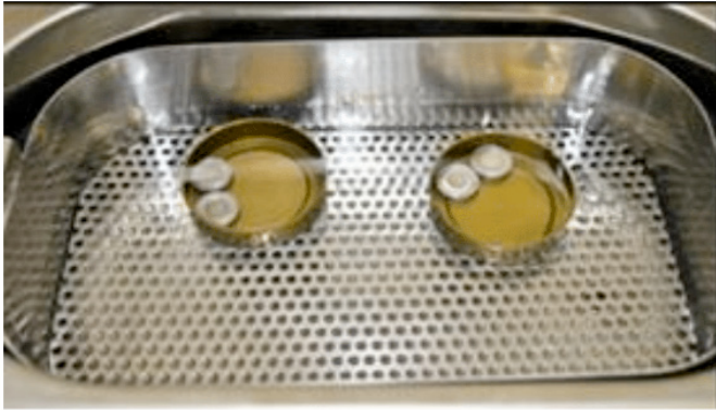
Figura 7: Corpos de prova na cuba ultrassônica
